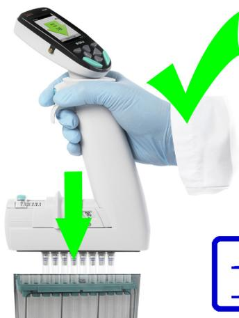
Abb. B6. Einsetzen von ClipTip-Spitzen 96-Well-Format
